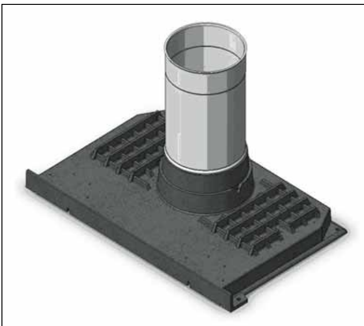
Figure 12 - Exemple de jonction du conduit de raccordement dans le manchon (femelle)
