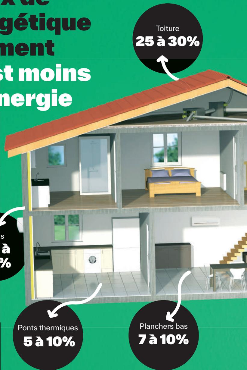
Schéma des pertes de chaleur d'une maison construite avant 1974 et non isolée (Source ADEME)
